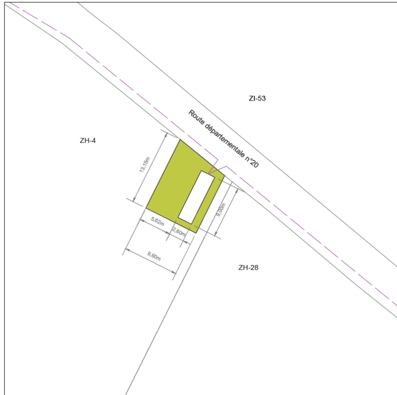
Figure 28 : Plan de masse du poste de livraison
